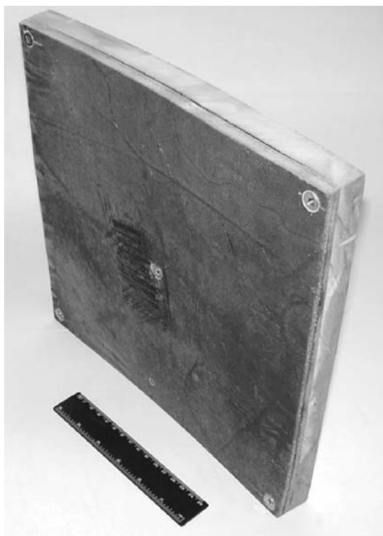
Рис. 6. Зразок покриття на фрагменті ТПК
