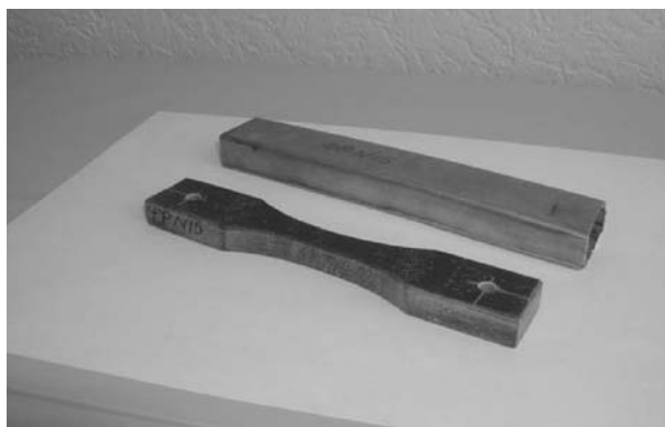
Рис. 2. Зовнішній вигляд зразка після опромінювання
