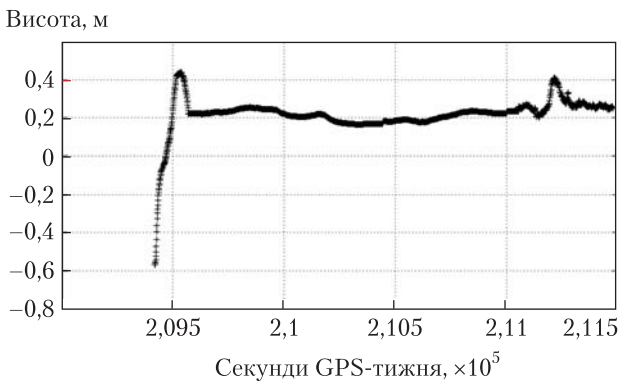
Рис. 14. Нев'язки DGPS-рішення по висоті. Розрахункова висота. Відстань 40 км
