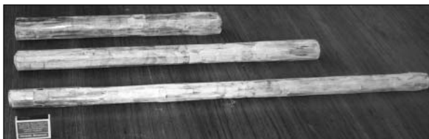
Рис. 3. Кованые заготовки из гафния на разных этапах передела
