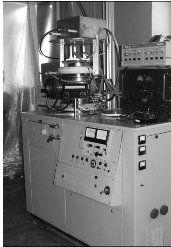
Вакуумно-плазмовий модуль для формування структур елементної бази нанoeлектроніки та мікроенергетики
