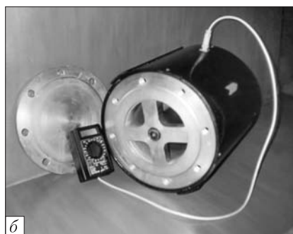
Рис. 5. Активаторы: а — производительность 1 200 м 3 /ч; б — производительность до 200 м 3 /ч
