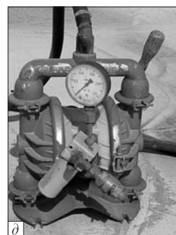
Рис. 1. Складові частини комплексу гідроабразивного очищення: а – установка гідроабразивного очищення; б – компресор ATLaS Copco XAHS106; в – резервуар для води; г – установка транспортування відпрацьованого абразиву; д – установка транспортування відпрацьованої води
