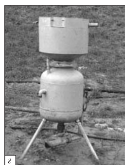
Рис. 1. Складові частини комплексу гідроабразивного очищення: а – установка гідроабразивного очищення; б – компресор ATLaS Copco XAHS106; в – резервуар для води; г – установка транспортування відпрацьованого абразиву; д – установка транспортування відпрацьованої води
