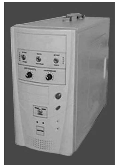
Рис. 1. Сварочные комплексы и инструменты для операций по соединению мягких живых тканей
