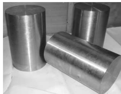
Рис. 3. Зливки зі сплаву Zr1Nb, отримані методом подвійного ВДП
