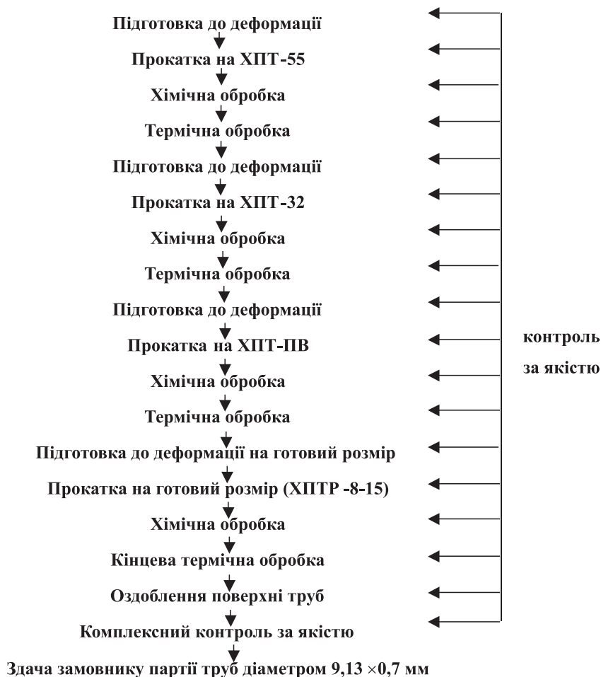
Рис. 8. Принципова схема операцій при виготовленні холоднодеформованих труб діаметром 9,13×0,7 мм зі сплаву Zr1Nb
