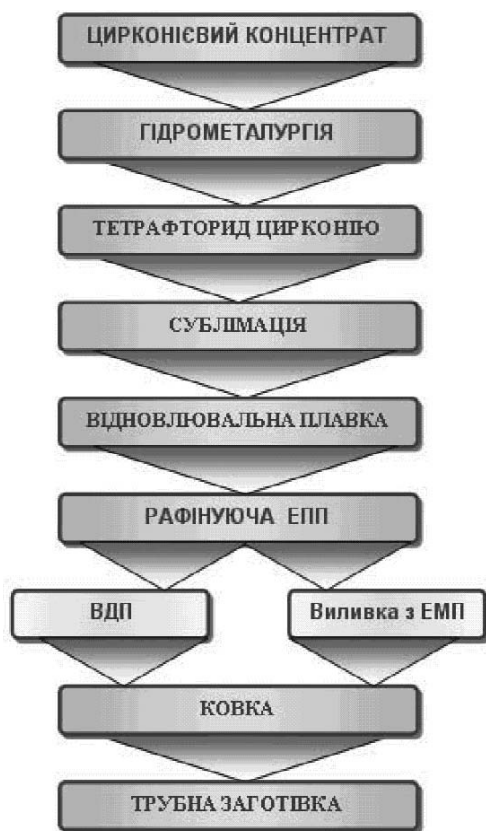
Рис. 1. Загальна схема отримання цирконію та зливків зі сплаву Zr1Nb для трубних заготовок, яку передбачається запровадити на ДНВП "Цирконій"
