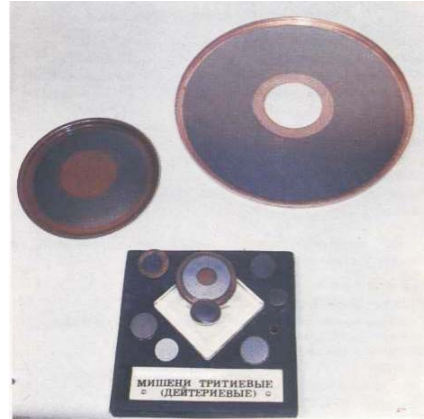
Рис. 1. Мішені, що містять тритій для нейтронних генераторів
